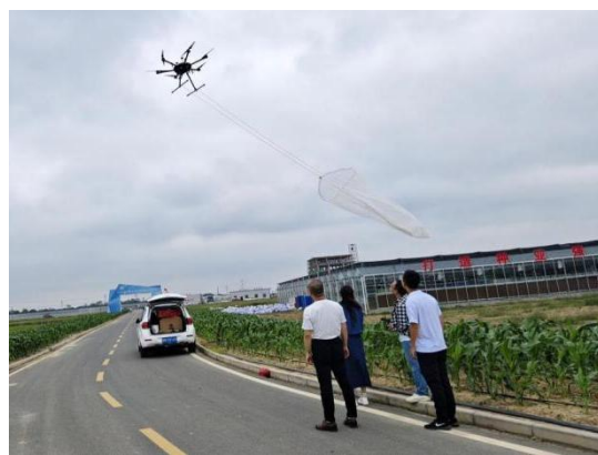
图3-4 旋翼机连续飞行20分钟捕捉昆虫
